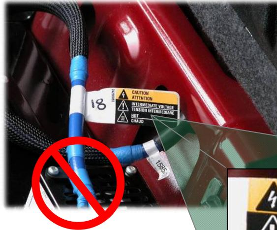
**MISE EN GARDE : Couper le câble de voltage intermédiaire peut résulter en un risque d'arc électrique.**
