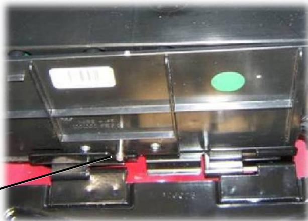
Un boulon à tête hexagonale de 10 mm fixe solidement en place le module de commande de débranchement de la batterie de 36 volts.
