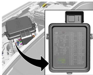
Si l'avertisseur doit être désactivé avant le transport, repérer et retirer le fusible d'avertisseur du centre électrique sous le capot.
