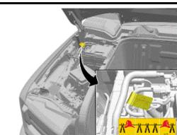
Les coussins gonflables peuvent être désactivés en retirant le câble négatif de la batterie 12 V. Ceci est destiné à désactiver l'alerte et l'atténuation de l'emballement thermique.
