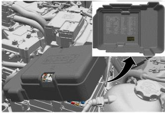
Si l'avertisseur doit être désactivé avant le transport, repérer et retirer le fusible d'avertisseur du centre électrique sous le capot.
