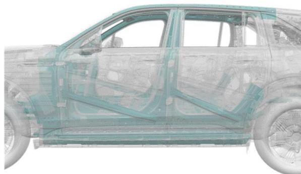
L'habitacle est protégé par de l'acier haute résistance dans les montants, les bas de caisse, les poutrelles de renfort des portes et la structure du plancher.
