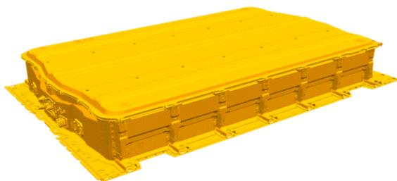
La batterie est un bloc Li-ion haute tension (classe B), qui est monté sous le véhicule et constitue une partie structurelle du plancher.
