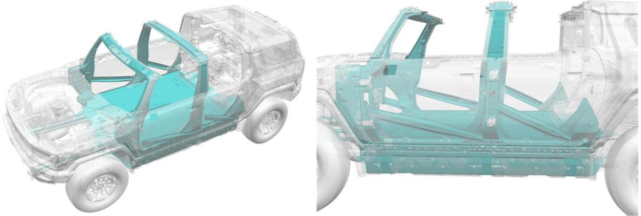
L'habitacle est protégé par de l'acier haute résistance dans les montants, les bas de caisse, les poutres de renfort des portes et la structure du plancher.
