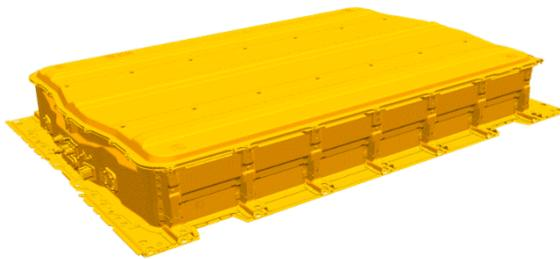
La batterie est un bloc Li-ion haute tension (classe B), qui est monté sous le véhicule et constitue une partie structurelle du plancher.
