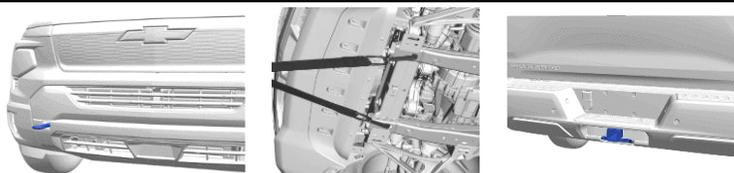
Le véhicule est équipé de points de fixation spécifiques à utiliser pour tirer le véhicule sur une remorqueuse à plateau à partir d'une surface de route plane. Ne pas utiliser ces points de fixation pour extraire le véhicule de la neige, de la boue, du sable ou d'un fossé.
