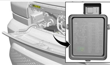
Si l'avertisseur doit être désactivé avant le transport, repérer et retirer le fusible d'avertisseur du centre électrique sous le capot.
