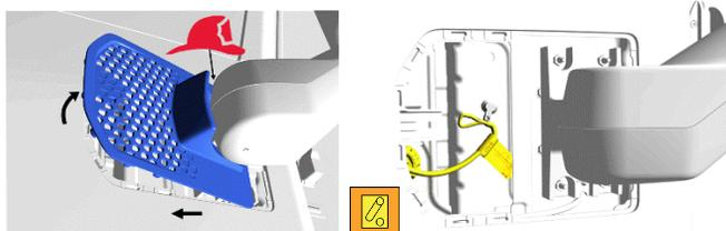
Les coussins gonflables peuvent être désactivés en retirant le câble négatif de la batterie 12 V. Ceci est destiné à désactiver l'alerte et l'atténuation de l'emballement thermique.
