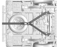
Le véhicule a des points de fixation spécifiques à utiliser pour tirer le véhicule sur un porte-voiture à plate-forme à partir d'une surface plane de la route. N'utilisez pas ces points de fixation pour tirer le véhicule de la neige, de la boue, du sable ou du fossé.
