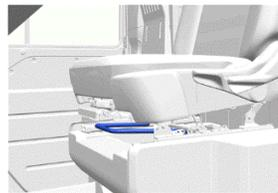
Dispositif de réglage vers l'avant et l'arrière
