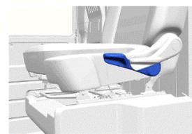
Dispositif de réglage de la hauteur
