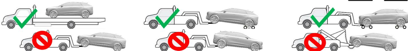
Le déplacement du véhicule avec les roues motrices au sol génère de l'énergie indésirable. Limiter le mouvement du véhicule à la distance nécessaire pour préparer le véhicule au remorquage.
