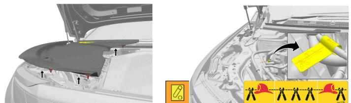
Les coussins gonflables peuvent être désactivés en retirant le câble négatif de la batterie 12 V. Ceci est destiné à désactiver l'alerte et l'atténuation de l'emballement thermique.
