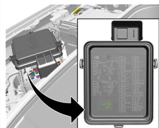
Si l'avertisseur doit être désactivé avant le transport, repérer et retirer le fusible de l'avertisseur du centre électrique sous le capot.
