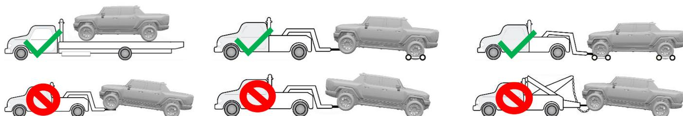
Le déplacement du véhicule avec les roues motrices au sol génère de l'énergie indésirable. Limiter le mouvement du véhicule à la distance nécessaire pour préparer le véhicule au remorquage.
