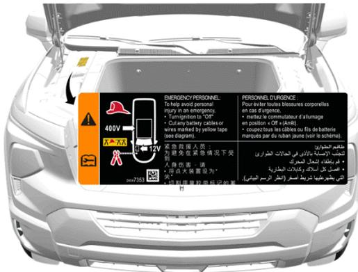
L'étiquette d'avertissement de la batterie est située sur le pare-brise du compartiment avant, sur le côté droit du véhicule.
