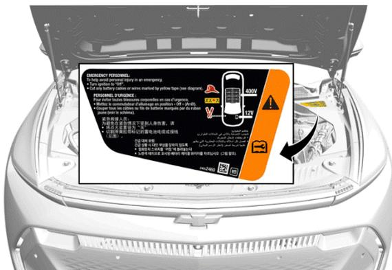
L'étiquette d'avertissement de la batterie est située sous l'écran pare-vue du compartiment avant central, au centre du panneau de la grille d'entrée d'air.
