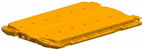
La batterie est un bloc Li-ion haute tension (classe B), qui est monté sous le véhicule et constitue une partie structurelle du plancher.
