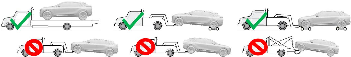
Le déplacement du véhicule avec les roues motrices au sol génère de l'énergie indésirable. Limiter le mouvement du véhicule à la distance nécessaire pour préparer le véhicule au remorquage.
